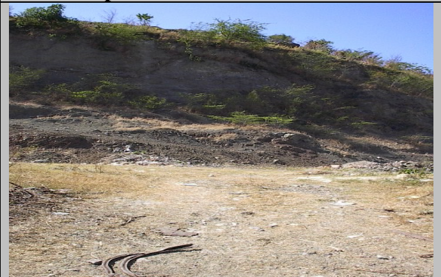
Micro 7 en el Distrito José Martí, rocas vulcanógenas sedimentarias en pendientes de 90° muy estables.
