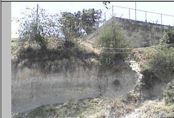
Escuela de artes y oficios, donde se observa la marga en taludes casi verticales, con buena estabilidad.
